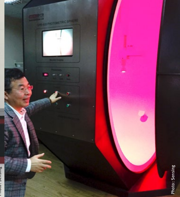
牟教授所指的是光度球，用于测量光源的发光效率和颜色特性。
