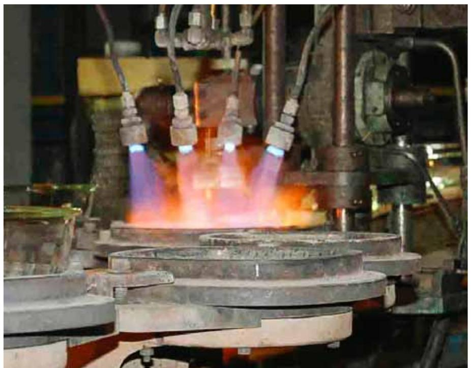
Des brûleurs de réchauffage maintiennent les équipements à une température élevée pour éviter un choc thermique sur le verre.
